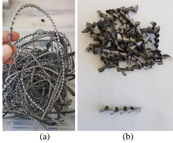
**Şekil 1.** a) CNC tekniği sırasında açığa çıkan alüminyum atığı, b) Kırılmış atık alüminyum
