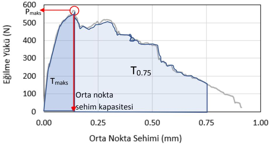
**Şekil 2.** Örnek yük-sehim eğrisi ve parametrelerin belirlenmesi
